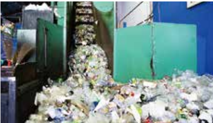
ライン（コンベヤ）。粗選別したものを載せる
