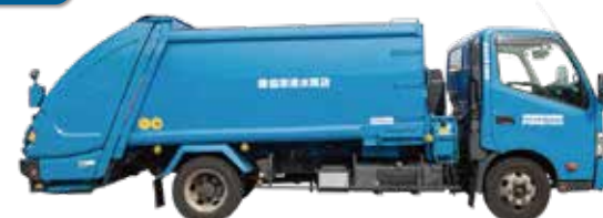
古紙専用パッカー車 段ボールなどの回収に使われます
